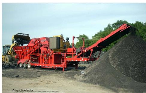
Reciclagem de concreto asfáltico em agregados.
