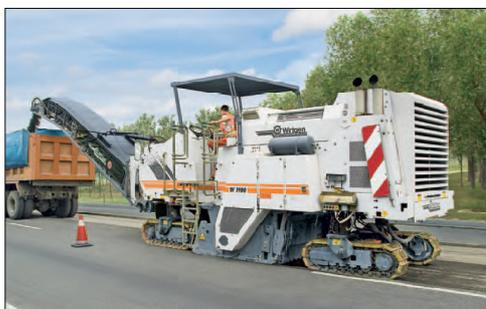
Fresa removendo pavimento em concreto asfáltico.
