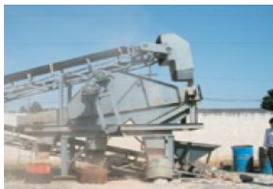
*Secagem e trituração em usina recicladora (emite um certificado para a construtora que enviou o resíduo)*
